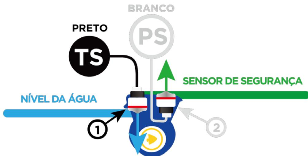
**Importante:** Para bom funcionamento do aparelho, certifique-se de que os Sensores estejam totalmente conectados ao suporte magnético, e que o mesmo, esteja posicionado a 90° no reservatório. Caso contrário, eles poderão não funcionar corretamente.
